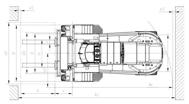
Ast=16+Wa+x+a L6: load length a: Clearance (200mm)
